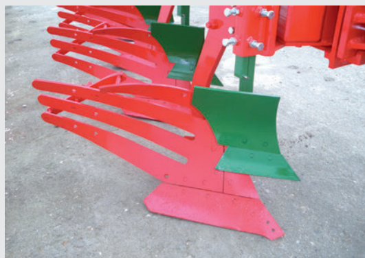
Rasetas / Vertedera de láminas.
